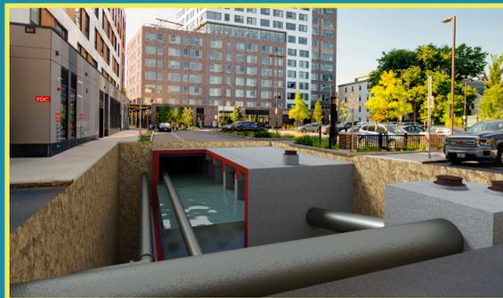
Una representación del tanque para aguas pluviales terminado
