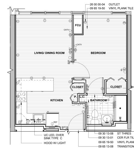
3 TYPE A UNIT FINISH PLAN & SCHEMATIC POWER
