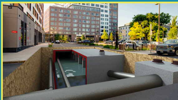
Uma renderização do tanque de águas pluviais finalizado com o Market Central ao fundo.
